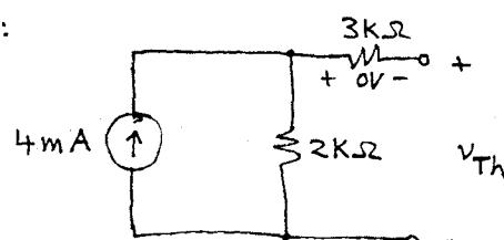
$$V_{Th} = 4\text{mA} \cdot 2\text{k}\Omega = 8\text{V}$$
