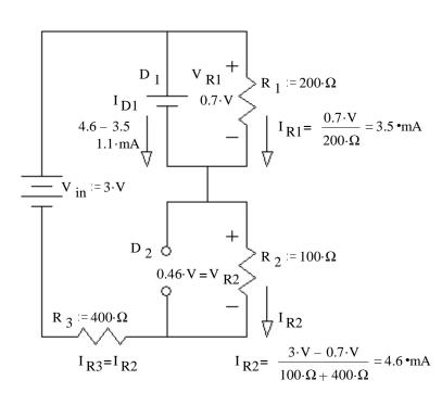
$$V_{R2} = 4.6 \cdot \text{mA} \cdot 100 \cdot \Omega = 0.46 \cdot \text{V}$$
