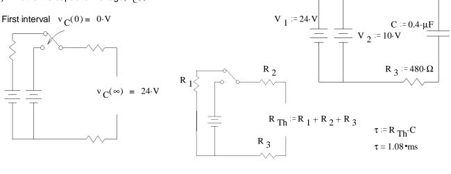
$$v_{C}(t) = v_{C}(\infty) + \left(v_{C}(0) - v_{C}(\infty)\right) \cdot e^{-\frac{t}{\tau}} = 24 \cdot V + (0 \cdot V - 24 \cdot V) \cdot e^{-\frac{t}{1.08 \cdot ms}}$$
