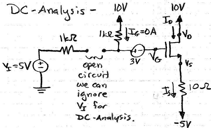
Note:  $I_G = 0A$ , so  $V_G = 10V - 3V = 7V$
