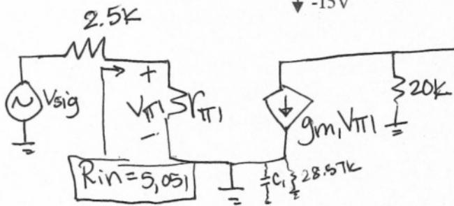
$$V_1 = -g_{m1} V_{\pi 1} \frac{(20k \parallel 164k) \parallel (r_{\pi 2} + (13k \parallel 1k)(\beta+1))}{17,826 \parallel 96,342}$$
