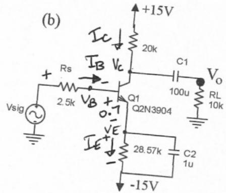
$$V_{\text{sig, DC}} = 0 \quad \text{DC: open caps}$$
