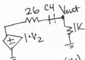
$$V_{out} \approx V_2 \frac{(1k)}{1k + 20k} = 0.97 V_2$$
