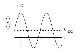
$$= \sqrt{\frac{1}{T} \cdot \int_{0}^{T} \left[ \left( V_{p} \cdot \cos(\omega \cdot t) \right)^{2} + 2 \cdot \left( V_{p} \cdot \cos(\omega \cdot t) \right) \cdot V_{DC} + V_{DC}^{2} \right] dt}$$
