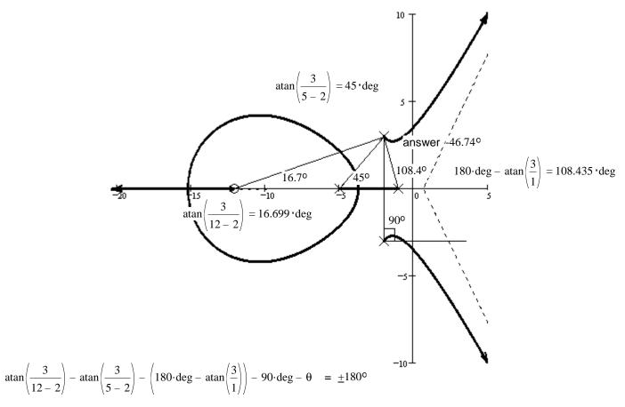
$\theta = 180 \cdot \text{deg} + 16.699 \cdot \text{deg} - 45 \cdot \text{deg} - 108.435 \cdot \text{deg} - 90 \cdot \text{deg} = -46.736 \cdot \text{deg}$
